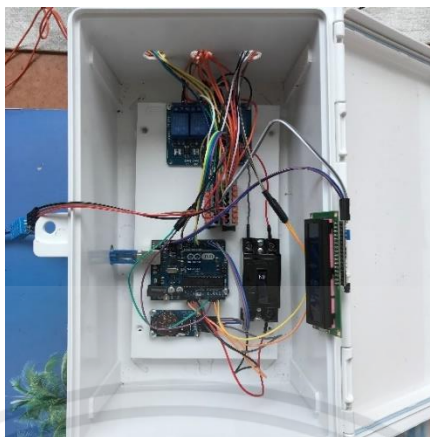
รูปที่ 4.2 กล่องควบคุมความชื้นในดิน
