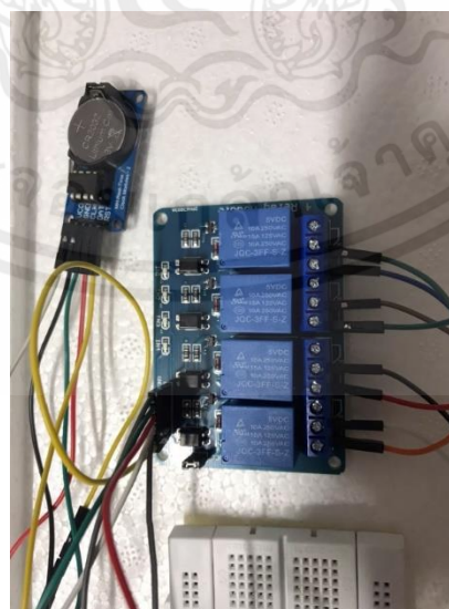
รูปที่ 3.9 Relay Module ไม่ทำงาน
