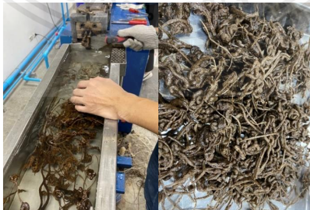
รูปที่ 4.5 ผลจากการผสมเส้นใยผักตบชวากับ PLA ที่อัตราส่วนเส้นใย 8 wt%
