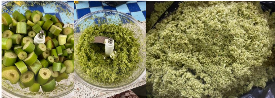
รูปที่ 3.3 ปั่นผักตบชวาด้วยเครื่องปั่นละเอียด
