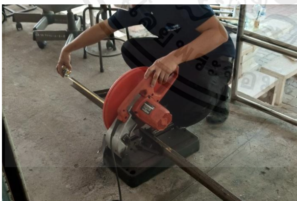
รูปที่ 4.11 ขั้นตอนการตัดเหล็กตัวซี
