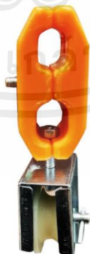
รูปที่ 3.21 ลูกรอกขนาดเส้นผ่านศูนย์กลาง 2.5 เซนติเมตร
