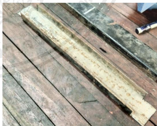
รูปที่ 4.12 เหล็กตัวซีที่ตัดปลายส่วนเกินออก
