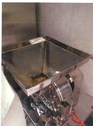
ภาพที่ 3.3 บดยุ่งมะขามด้วยเครื่อง Hammer mill
