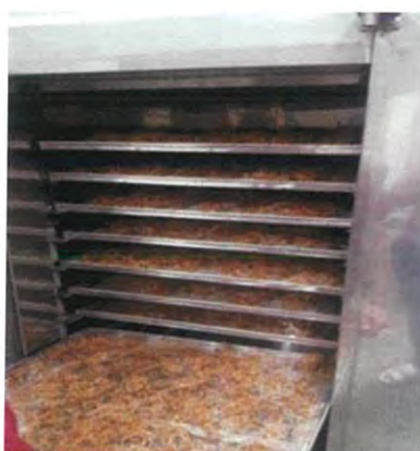
ภาพที่ 3.2 อบแห้งด้วยเครื่องอบแห้งแบบถาด
