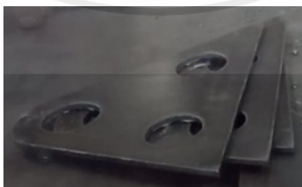
รูปที่ 4.3 ตัดตามแบบ เจาะรู 3 รู หลังเสร็จสิ้นกระบวนการ
