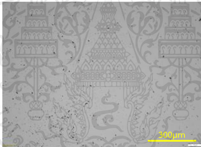
รูปที่ 4.8 พื้นผิวของโลหะผสมโคบอลต์โครเมียมโมลิบดีนัมเจือแทนทาลัมก่อนการทดสอบการกัดกร่อน
