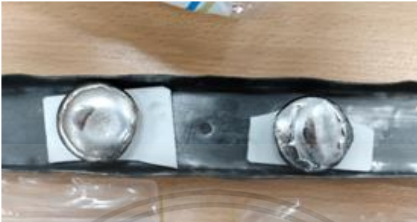
รูปที่ 3.6 ชิ้นงานก่อนทำการอบเพื่อให้เป็นเนื้อเดียว
