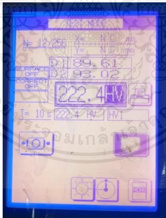
รูปที่ 3.17 ภาพตัวอย่างหน้าจอขณะทำการทดสอบความแข็ง
