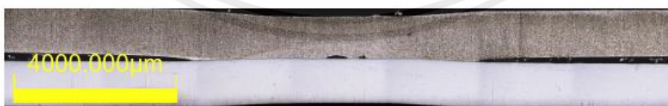
รูปที่ 4.11 โครงสร้างมหภาครอยเชื่อมของลำดับการทดลองที่4 เชื่อมความต้านทานแบบจุดด้วยกระแสพัลส์ที่หนึ่งและสอง 10,000 และ 10,000 แอมแปร์ ตามลำดับ ระยะเวลากระแสพัลส์ที่หนึ่งและสอง 15 และ 25 ไชเคิล ตามลำดับ
