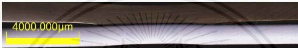
รูปที่ 4.13 โครงสร้างมหภาครอยเชื่อมของลำดับการทดลองเปรียบเทียบ เชื่อมความต้านทานแบบจุดด้วยกระแสพัลส์ที่หนึ่ง 10,000 แอมแปร์ และระยะเวลากระแสพัลส์ที่หนึ่ง 15 ไซเคิล
