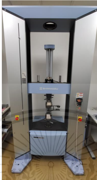
รูปที่ 3.6 เครื่องทดสอบแรงดึง SHIMADZU Autograph AG-X-100KN
