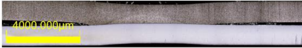
รูปที่ 4.8 โครงสร้างมหภาครอยเชื่อมของลำดับการทดลองที่1 เชื่อมความต้านทานแบบจุดด้วยกระแสพัลส์ที่หนึ่งและสอง 10,000 และ 5,000 แอมแปร์ ตามลำดับ ระยะเวลากระแสพัลส์ที่หนึ่งและสอง 15 และ 5 ไชเคิล ตามลำดับ
