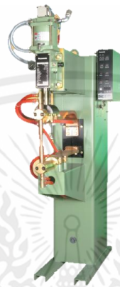
รูปที่ 3.4 เครื่องเชื่อมความต้านทานแบบจุด PANASONIC YR-500CM2 [33]
