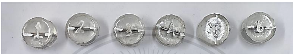
รูปที่ 3.10 ชิ้นงานที่ถูกขึ้นเรือนแบบเย็น
