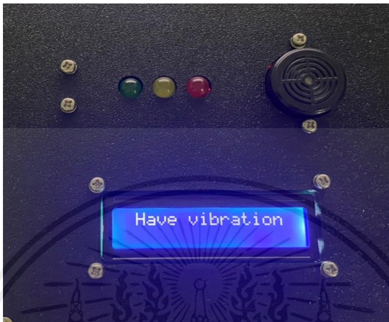
รูปที่ ก.7 หน้าจอ LCD แสดงผลลัพธ์จากการตรวจพบการสั่นสะเทือน
