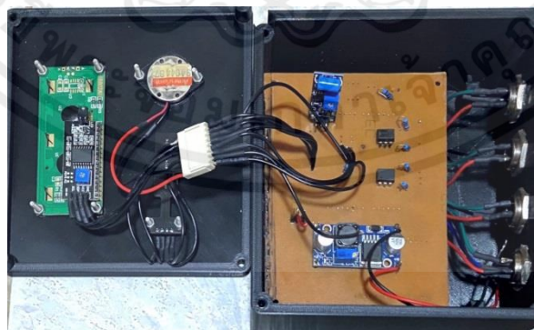
รูปที่ 3.19 กล่องอุปกรณ์วัดค่าทางกระบวนการ
