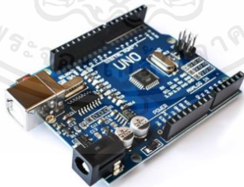
รูปที่ 2.3 บอร์ด Arduino รุ่น UNO R3
