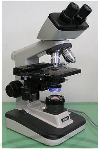
รูปที่ 2.6 กล้องจุลทรรศน์แบบใช้แสง (OM) [17]
