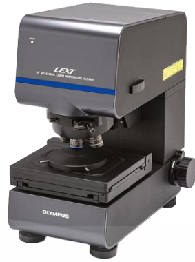
รูปที่ 2.8 กล้องจุลทรรศน์แบบคอนโฟคอล [19]
