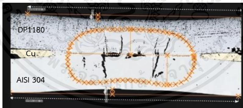
รูปที่ 4.4 ตัวอย่างโครงสร้างมหภาคจากการทดลองกรณีใช้โลหะเต็ม
