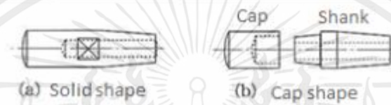
รูปที่ 2.3 รูปร่างมาตรฐานของอเล็กโทรด [7]
