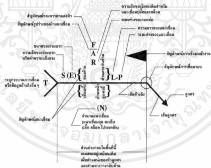
รูปที่ 2.21 ส่วนต่างๆ ของสัญลักษณ์งานเชื่อมตามมาตรฐาน AWS
