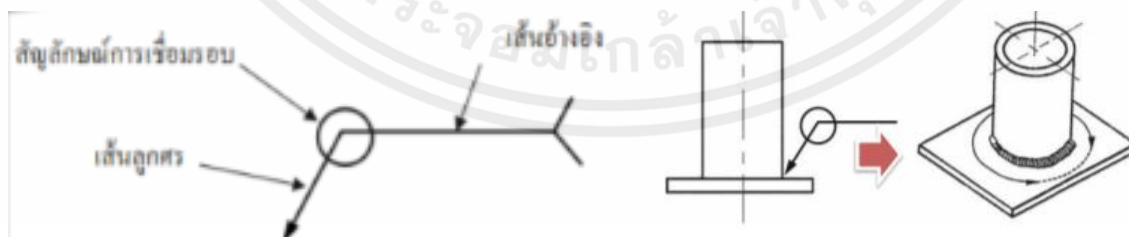
รูปที่ 2.26 การเชื่อมรอบชิ้นงาน
