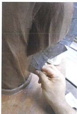
รูปภาพที่ 3.41 กรีดแบ่งงานและเสียบแผ่นสังกะสีกั้นงาน
