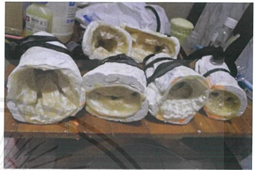
รูปภาพที่ 3.89 ประกบพิมพ์ท่ายางพารา 4 รอบ
