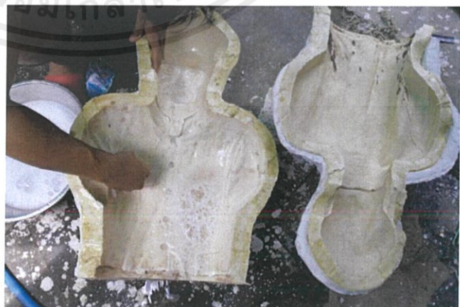
รูปภาพที่ 3.52 ทำความสะอาดพิมพ์
