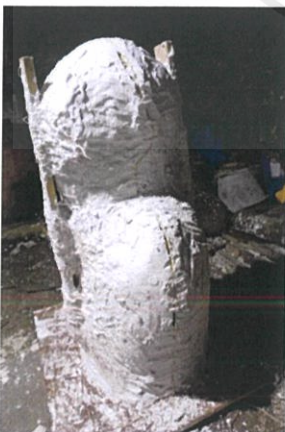
รูปภาพที่ 3.51 เตรียมแกะพิมพ์
