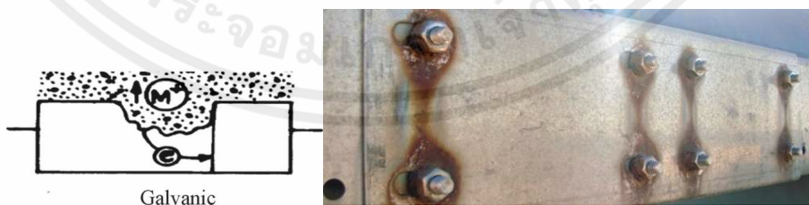
รูปที่ 2.21 การกัดกร่อนเนื่องจากความต่างศักย์
