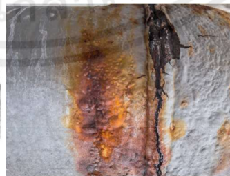
รูปที่ 2.27 การกัดกร่อนโดยความเค้น
