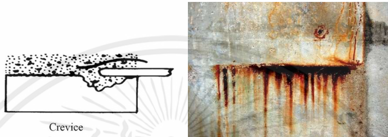
รูปที่ 2.22 การกัดกร่อนแบบช่องแคบ
