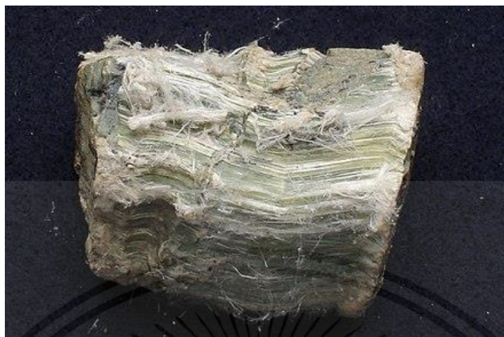
รูปที่ 2.1 ลักษณะของใยหิน (Chrysotile) ที่ใช้ในปัจจุบัน [9]
