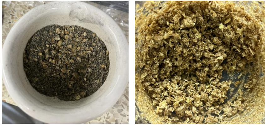
รูปที่ 3.10 การผสมซังข้าวโพดและท่อนาโนคาร์บอนร่วมกับกาวพลาสติกเรซิน โดยซังข้าวโพดผสมกับท่อนาโนคาร์บอนในโถรงบด (ซ้าย), การผสมซังข้าวโพดกับกาวพลาสติกเรซิน (ขวา)
