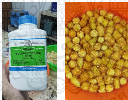
รูปที่ 3.5 สารเคมีโซเดียมไฮดรอกไซด์ (ซำย), ตัวอย่างการแช่ปรับสภาพทางเคมีซังข้าวโพด (ขวา)
