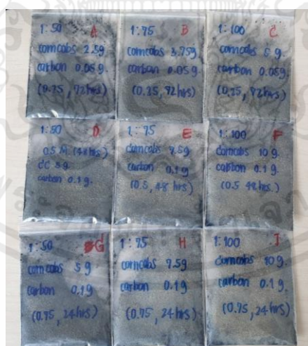
รูปที่ 3.8 สิ่งทดลองหลังการผสมผงซังข้าวโพดและท่อนานคาร์บอนเข้าด้วยกันตามอัตราส่วน ๆ
