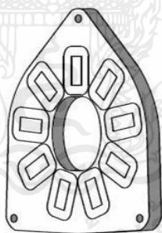
รูปที่ 2.21 ตัวอย่างสเตเตอร์แบบ Axial Flux
