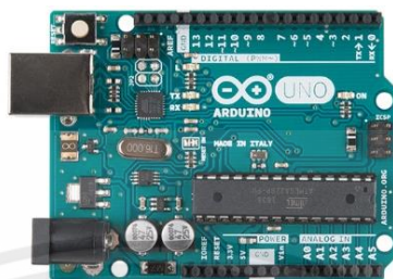
รูปที่ 3.5 Arduino Uno3
