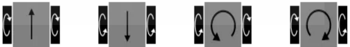
รูปที่ 2.2 รูปแบบการเลี้ยว ของรถยนต์ Differential Drive
