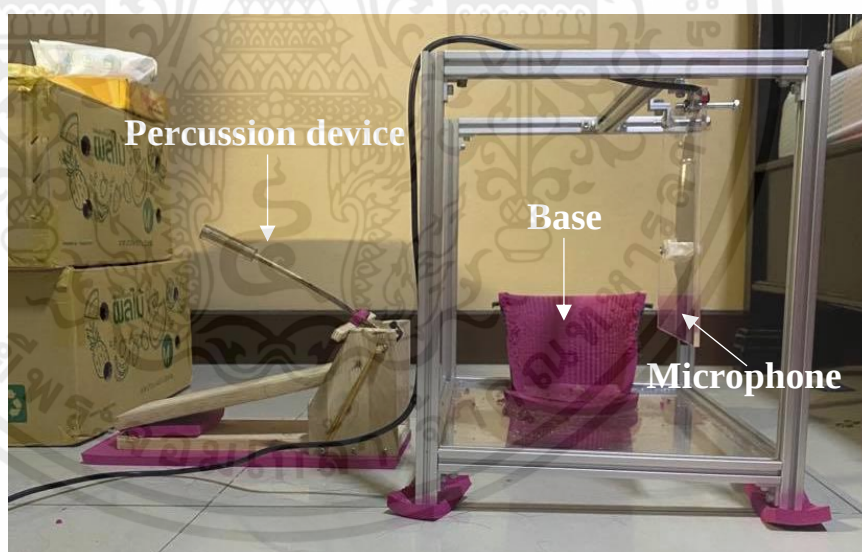
รูปที่ 4.23 การวิเคราะห์ความถี่เสียงจากทุเรียนหมอนทอง กรณีใช้กระต๋องประดิษฐ์เป็นอุปกรณ์ในการกำเนิดเสียงด้วยแรงที่คงที่
