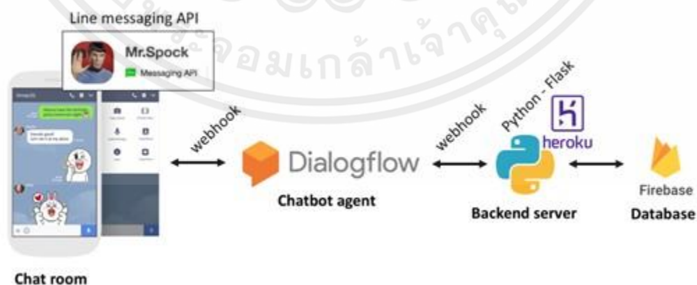
รูปที่ 2.13 การเชื่อมต่อ Dialogflow กับไลน์แชทบอท (Witchapong Daroontham, 2561)
