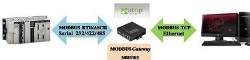
รูปที่ 2.8 การแปลง MODBUS Serial เป็น MODBUS Ethernet (Keerati Rounghirun, 2662)
