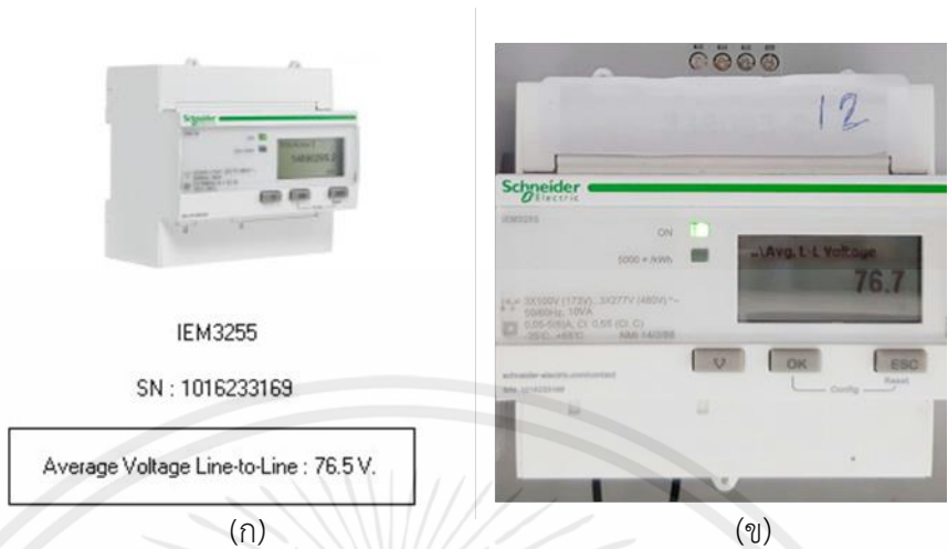
รูปที่ 4.2 (ก) หน้าต่างแสดงค่าแรงดันไฟฟ้าผ่านโปรแกรม Power Monitoring Expert ส่วน Vista (ข) การอ่านค่าแรงดันไฟฟ้าจากดิจิตอลมิเตอร์ ยี่ห้อ Schneider รุ่น IEM3255
