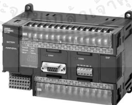
รูปที่ 2.1 PLC CP1H-XA ของบริษัท Omron
