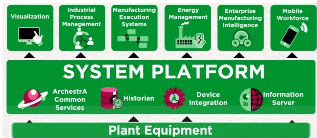
รูปที่ 2.9 แสดงส่วนประกอบของระบบ System Platform
