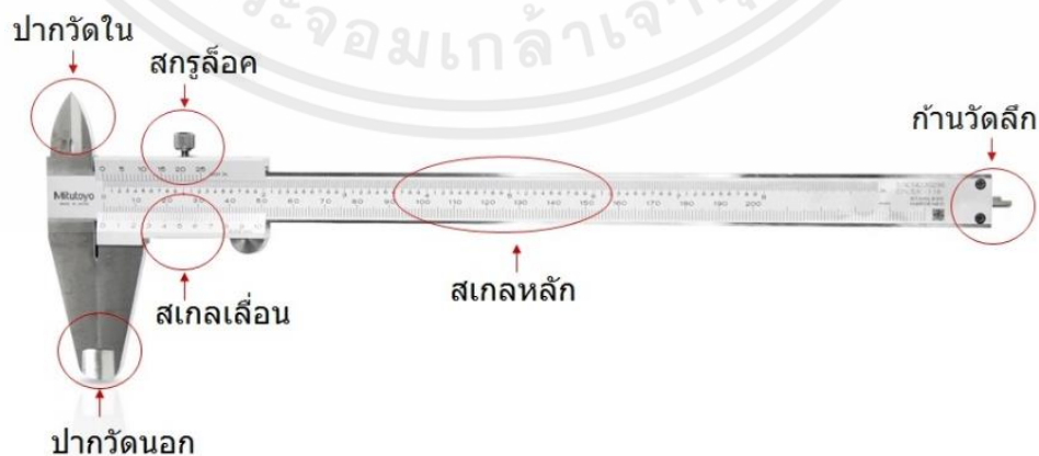
รูปที่ 2.6 แสดงส่วนประกอบหลักของเวอร์เนียคาลิเปอร์
