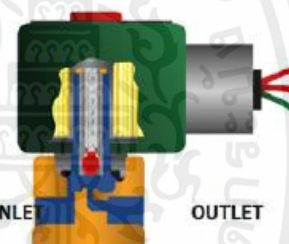
รูปที่ 2.18 เมื่อโซลินอยด์วาล์วมีการจ่ายไฟ
