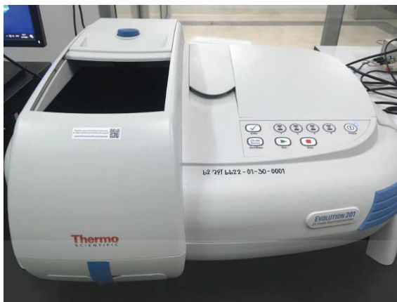
รูปที่ 3.3 เครื่องสเปกโตรมิเตอร์ชนิดอัลตราไวโอเล็ต-วิสิเบิล แบบลำแสงคู่ รุ่น Thermo Evolution 201
