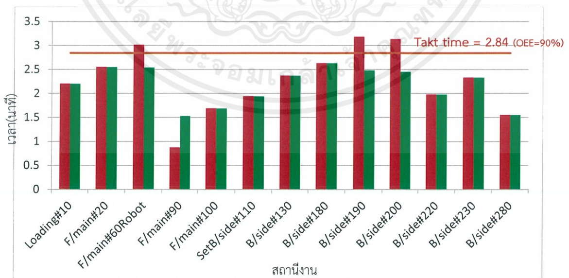
รูปที่ 5.13 แผนภูมิรอบเวลาในแต่ละสถานีงานในสายการประกอบ Gonnims Main ของรถรุ่น Double Cab
