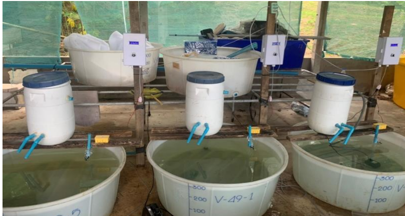
ภาพที่ 8 ถังและอุปกรณ์ที่ติดตั้งชุดต้นแบบการควบคุมวัดความขุ่นของสีน้ำแบบอัตโนมัติ
