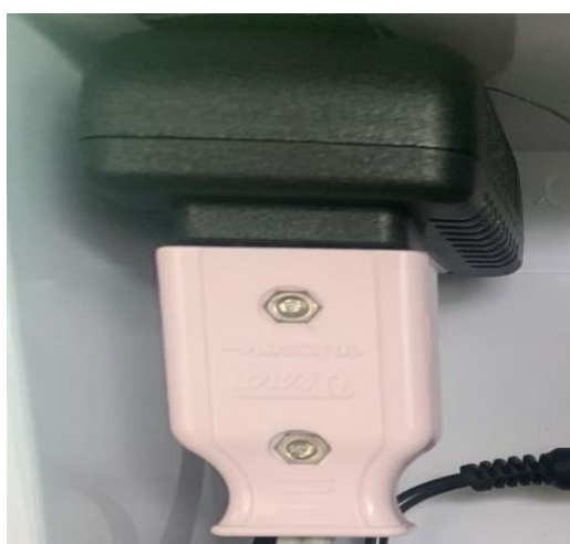
ภาพที่ 6 Adapter 9V 2A ในชุดต้นแบบการควบคุมความชุ่มชื้นของน้ำที่เลี้ยงปลากะพงขาวแบบอัตโนมัติ
