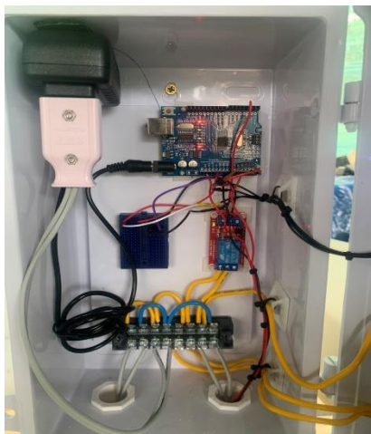
ภาพที่ 8 ถังและอุปกรณ์ที่ติดตั้งชุดต้นแบบการควบคุมวัดความขุ่นของสีน้ำแบบอัตโนมัติ
