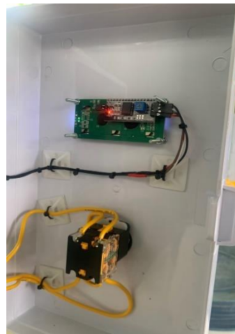
ภาพที่ 8 ถังและอุปกรณ์ที่ติดตั้งชุดต้นแบบการควบคุมวัดความขุ่นของสีน้ำแบบอัตโนมัติ
