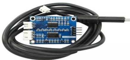
ภาพที่ 6 TDS Sensor ที่ใช้ในชุดต้นแบบการควบคุมของแข็งละลายน้ำอัตโนมัติ
