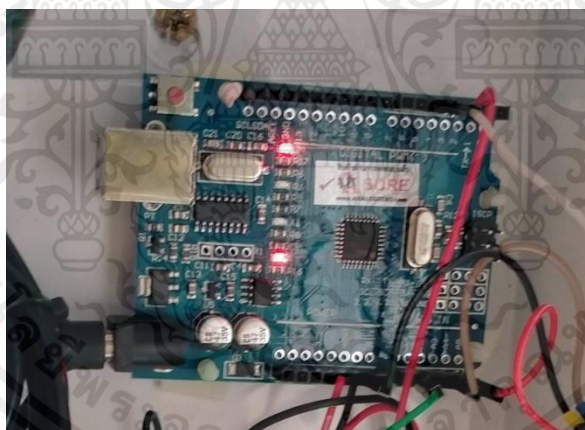
ภาพที่ 7 Arduino Uno ที่ใช้ในชุดต้นแบบการควบคุมของแข็งละลายน้ำอัตโนมัติสำหรับการเลี้ยงปลาคาร์พ
