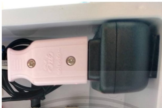
ภาพที่ 8 Adapter 9V 2A ที่ใช้ในชุดต้นแบบการควบคุมของเครื่องละลายน้ำอัตโนมัติสำหรับการเลี้ยงปลาคาร์ฟ
