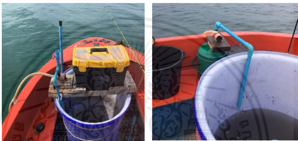
ภาพที่ 25 การทดสอบการไหลเวียนของน้ำทะเลจากทะเลธรรมชาติเข้าถังลำเลียงหมึกหอม
