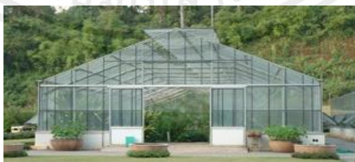
ภาพที่ 2.1 โรงเรือนหลังคาหน้าจั่วแบบสมมาตร
