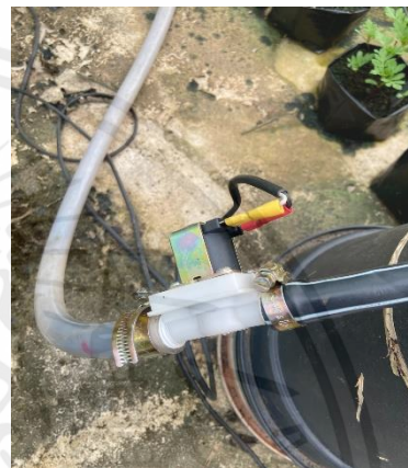
ภาพที่ 3.5 วาล์วน้ำไฟฟ้า 9 โวลต์
