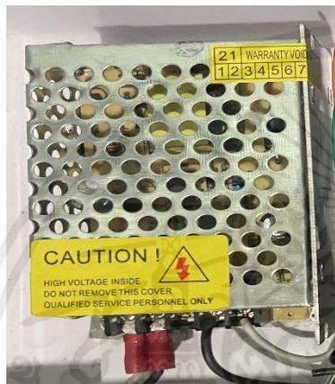
ภาพที่ 3.4 ชุดแปลงไฟ 220 โวลต์ เป็น 9 โวลต์
