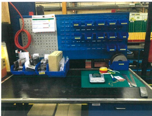
รูปที่ 4.2 โต๊ะแต่งผิวประจำสถานีงานเครื่องกัดห้าแกน Hermle
