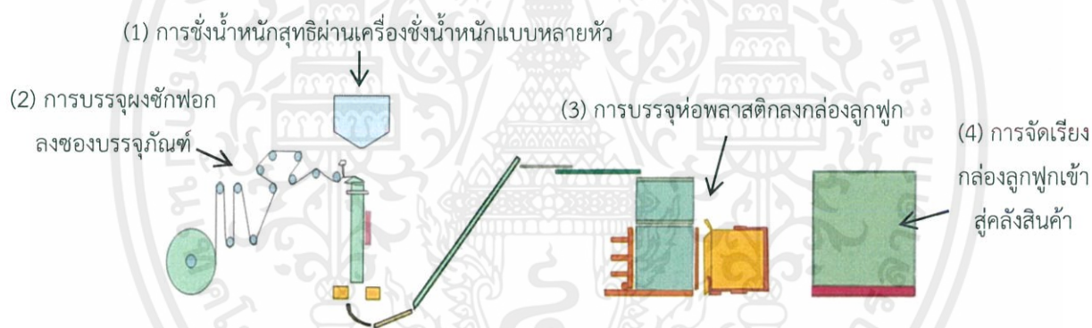
รูปที่ 3.7 กระบวนการบรรจุภัณฑ์ของแผนการบรรจุภัณฑ์ผงซีกฟอกสูตรมาตรฐานสายการผลิต D
