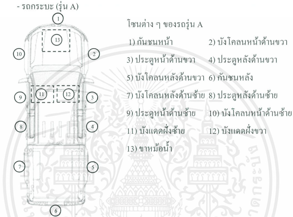
รูปที่ 3.14 ส่วนประกอบภายนอกของรถกระบะ (รุ่น A)
