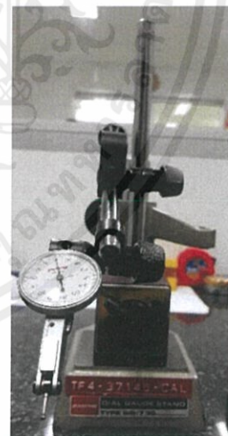
(ง) แท่นวางเครื่องมือและ Layer Type Dial Indicator
