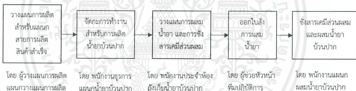
รูปที่ 3.11 กระบวนการวางแผนการผลิตผสมน้ำยาบ้วนปากและซึ่งสารเคมี
