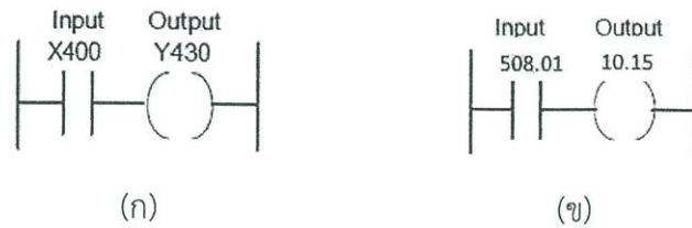
ภาพที่ 2.15 ลักษณะอินพุตและเอาต์พุตในพีแอลซี (ก) ผู้ผลิต Mitsubishi และ (ข) ผู้ผลิต Omron (Bolton W. 2006)
