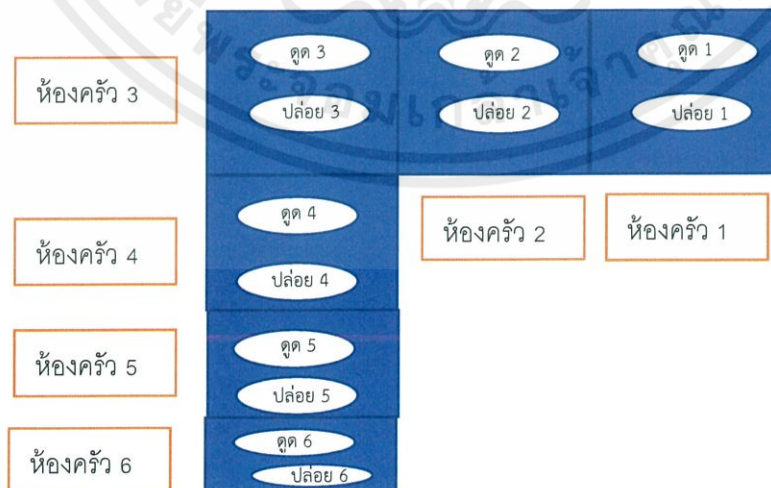
รูปที่ 3.3.14 แผนผังของ Cooker Hood ในห้องครัว
