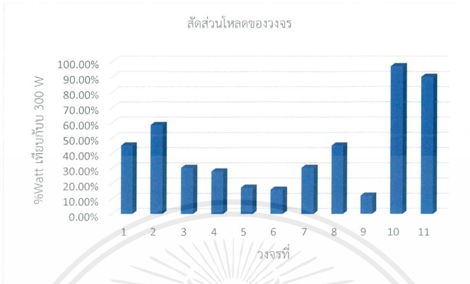
รูปที่ 3-5 กราฟแสดงสัดส่วนโหลดของวงจรตู้LO1 โครงการตัวอย่าง 3
