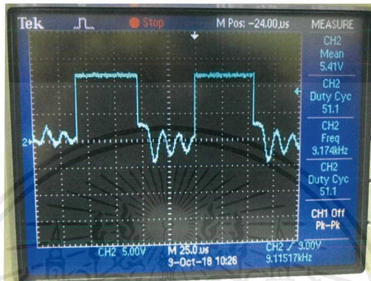
ภาพที่ 2.2 ตัวอย่างการควบคุมแรงดันไฟฟ้าโดยการปรับ Duty Cycle ไปที่ 50 % โดยประมาณ
