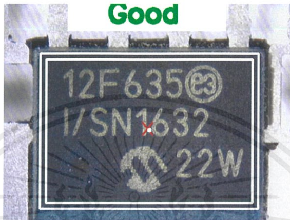
รูปที่4.6 การทำสัญลักษณ์อยู่ในตำแหน่งที่ผ่านมาตรฐานของแพ็คเกจ 8SOIC_STL
