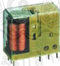
รูปที่ 2.4 Electromechanical แบบเก่าคลาลล่า
