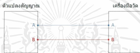
ตัวอย่าง การเชื่อมต่อ RS485 ระหว่างเครื่องมีวัดกับตัวแปลงสัญญาณ
