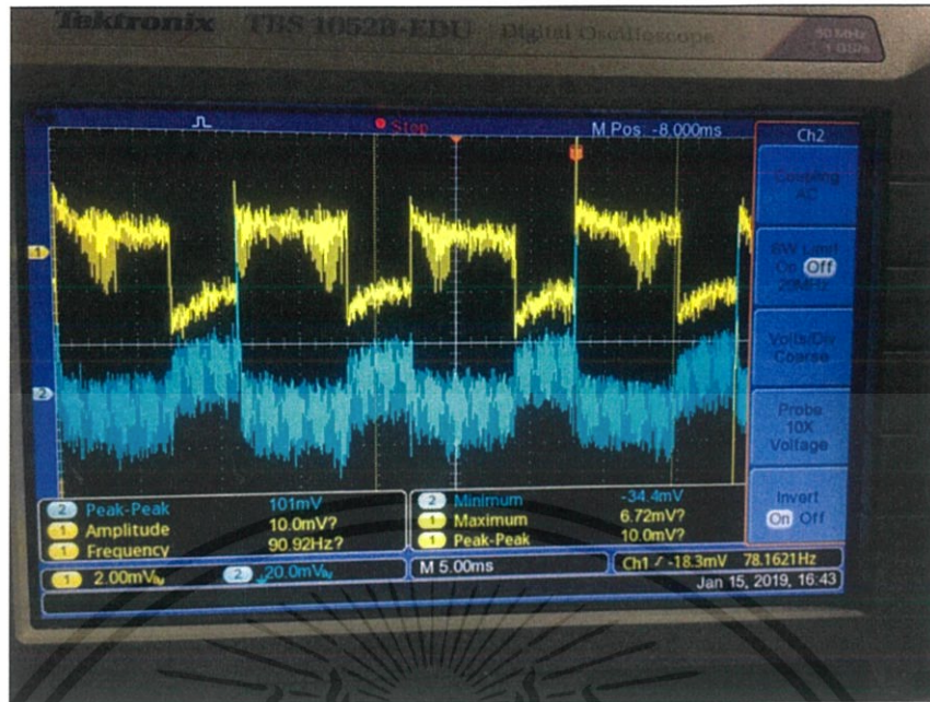
รูปที่ 4.4 ลักษณะสัญญาณเมื่อถูกแปลงรูปแบบการสื่อสาร
