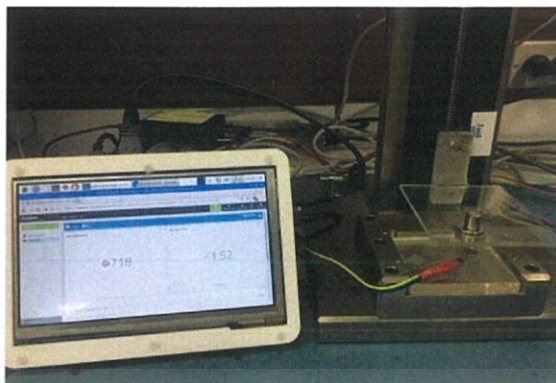
ภาพที่ 3.13 การวัดสนามแม่เหล็กที่ระยะทาง 23 มิลลิเมตร
