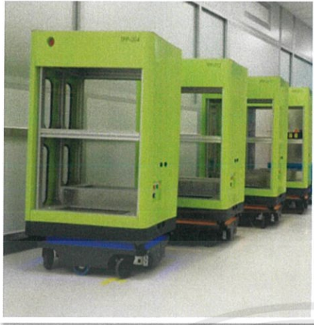
ภาพที่4-2 รูปจริงของ tray agv
