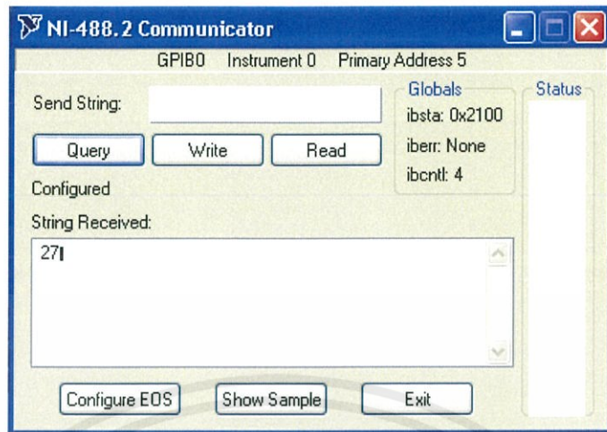
ภาพที่ 3.14 ภาพแสดงขณะที่เซ็นเซอร์มีอุณหภูมิ 27 องศาเซลเซียส
