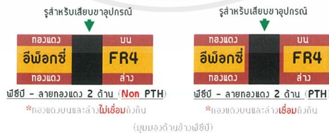
ภาพที่ 3.7 ความแตกต่างระหว่างพีซีบีแบบ Plated กับ Non-Plated Through Holes
