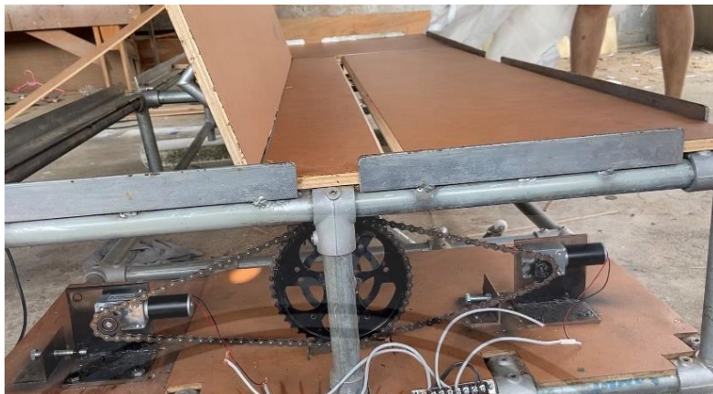
(ก) ทำการทดสอบการพลิกตะแคงด้านซ้ายโดยยังไม่มีน้ำหนักของผู้ป่วย (มองจากด้านท้าย)
