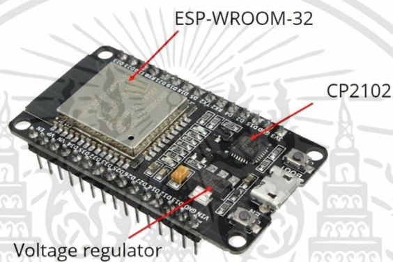
รูปที่ 3.9 ส่วนประกอบภายในบอร์ด ESP32 [11]
