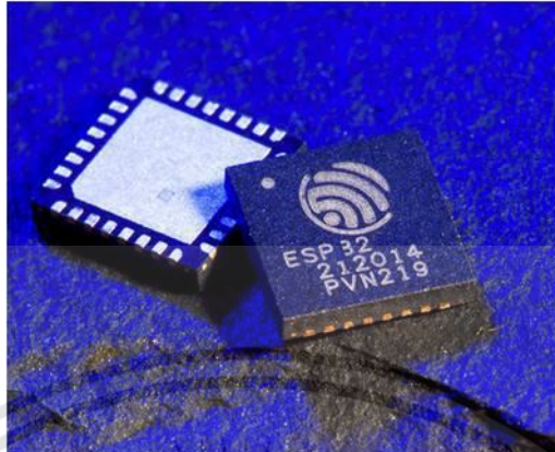
รูปที่ 2.1 ชิพไอซี ESP32 ในรูปตัวถัง QFN-42
