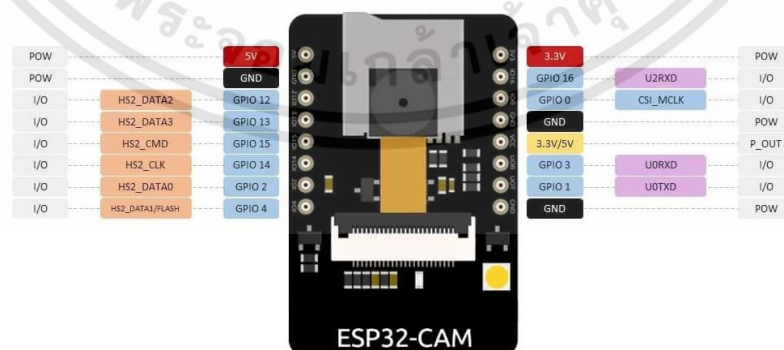
รูปที่ 2.50 แสดงขาของ ESP32 CAM
