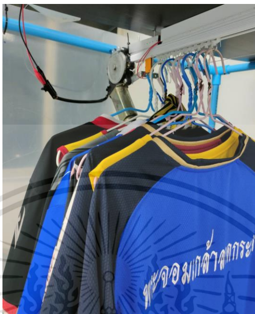
รูปที่ 3.29 ราวตากผ้าขณะตากเมื่อรอกเคลื่อนที่เข้า
