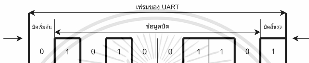
รูปที่ 2.9 รูปแบบการรับและส่งข้อมูล UART
